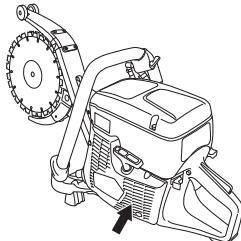
**ЗАМЕЧАНИЕ!** Загрязненный или закрытый воздухозаборник может привести к перегреву машины и вызвать повреждение поршня и цилиндра.
