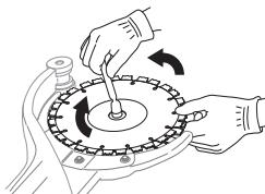
**ЗАМЕЧАНИЕ!** Диски должны вращаться при затянутой гайке. Это будет свидетельствовать о том, что ремень не зажат на дисках между объединенными половинами приводного ремня, когда диски и приводной ремень стягиваются с помощью гайки. Лучше это делать поочередно, то есть слегка затянуть, немного провернуть и так повторять, пока диски не будут закреплены.
