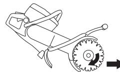
Не передвигайте машину, если резчик вращается. Гироскопические силы могут затруднить движение в выбранном направлении.
