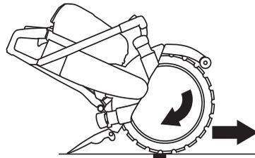
Не передвигайте машину, если резчик вращается. Гироскопические силы могут затруднить движение в выбранном направлении.
