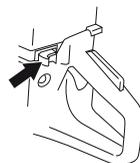
Проверка выключателя останки
