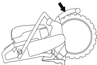
Проверка состояния режущего диска и его щитка.
